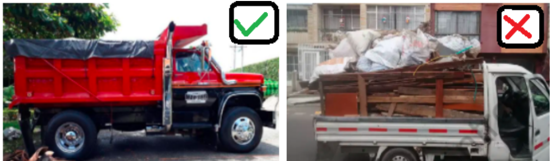
Imagen 3. Transporte correcto (izq) e incorrecto (der) de RCD
